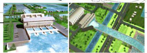
คลองระบายน้ำสุวรรณภูมิ และสถานีสูบน้ำ 100 ส.ม.วินาที
