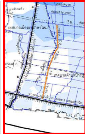
เสนอคลองระบายน้ำเพิ่มเติม รับน้ำจากคลองบัวคลีระบาย น้ำลงยังคลองชายทะเล รองรับการขยายตัวของพื้นที่ สีเหลืองที่จะเพิ่มขึ้น ขนาดเขต คลอง 60.00 เมตร
