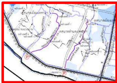
คลองระบายน้ำสำคัญที่ระบายน้ำจากนิคมบางปู และเพิ่มเติมสถานีสูบน้ำระบายน้ำออกสู่ทะเล
